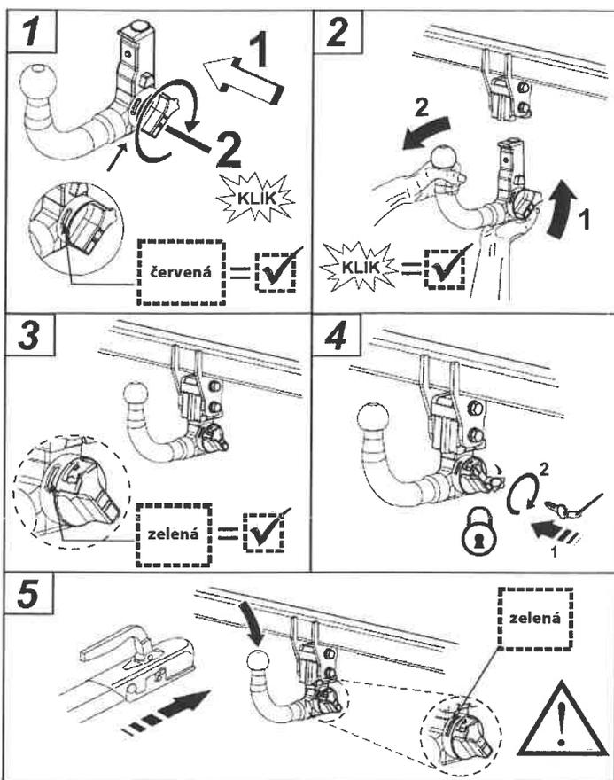
Demontáž (vyjmutí čepu z pouzdra) se provádí odpojením oje popř. dalšího příslušenství (lanko, el. kabeláž apod.). Odemkněte otočný volič klíčkem o 1/2 otáčky proti směru hodinových ručiček.
