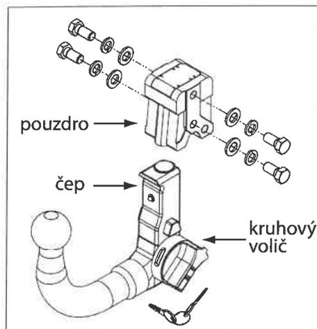
Při správném vložení čepu do pouzdra dojde k zacvaknutí a automatické změně indikátoru na zelenou barvu. Před každým použitím tažného zařízení nezapomeňte zkontrolovat správnou barvu na indikátoru! V případě správně provedené montáže je to barva zelená.
